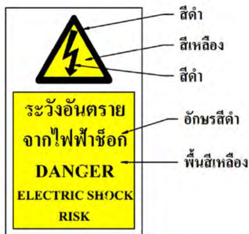
รูปที่ 10 ป้ายแสดงข้อความเตือนสำหรับเครื่องอัดประจุไฟฟ้า
